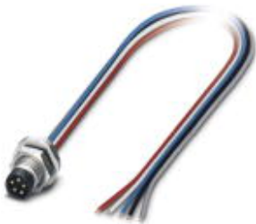
Bussystem-Einbausteckverbinder, Stecker, DeviceNet, 5-polig, M8, Vorderwand-/Schraubmontage mit M10 Befestigungsgewinde, mit 0,5 m TPE-Litze, 5 x 0,25mm²
