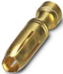
Gedrehter 2,5er Crimpkontakt, Buchsen-Einzelkontakt, Aderquerschnitt 0,5 mm 2 , vergoldet
