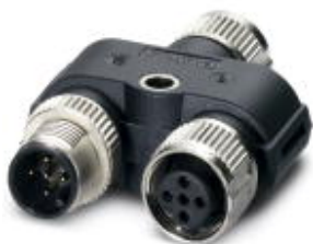
Y-Verteiler, 5-polig, geschirmt, Buchse gerade M12 SPEEDCON, A-kodiert, auf Buchse gerade M12 SPEEDCON, A-kodiert und Stecker gerade M12 SPEEDCON, A-kodiert
