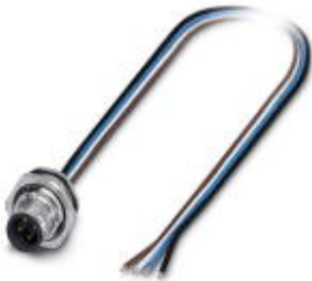
Sensor-/Aktor-Einbaustecker, 4-polig, M12-SPEEDCON, Hinterwand-/Schraubmontage mit Pg9-Gewinde, mit 0,5 m TPE-Litze, 4 x 0,34 mm 2
