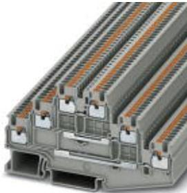
Mehrstock-Klemme, Querschnitt: 0,14 mm<sup>2</sup> - 1,5 mm<sup>2</sup>, AWG: 26 - 16, Anschlussart: Push-in-Anschluss, Breite: 3,5 mm, Farbe: grau, Montageart: NS 35/7,5, NS 35/15
