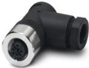
Sensor-/Aktor-Stecker, Buchse, gewinkelt, 5-polig, M12, Schraubanschluss, Edelstahlrändel, Kabelverschraubung Pg9
