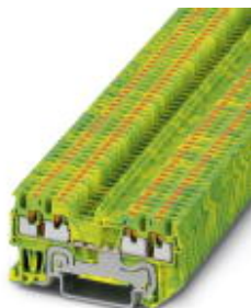
Schutzleiter-Reihenklemme, Anschlussart: Push-in-Anschluss, Querschnitt: 0,14 mm 2 - 1,5 mm 2 , AWG: 26 - 16, Breite: 3,5 mm, Farbe: grün-gelb, Montageart: NS 35/7,5, NS 35/15
