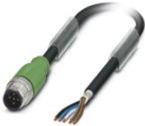
Sensor-/Aktor-Kabel, 5-polig, PUR halogenfrei, schwarzgrau RAL 7021, geschirmt, Stecker gerade M12, A-kodiert, auf freies Leitungsende, Kabellänge: 5 m
