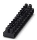
Europaklemmleiste aus Polypropylen, schwarz, zum Verbinden von starren Leitern und flexiblen Leitern mit und ohne Aderendhülse mit einem Querschnitt von 0,5 bis 4 mm²
