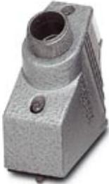
Tüllengehäuse aus Metall, Pulverbeschichtung, Verriegelungsschrauben mit Zylinderkopf, Bauform 1, Kabelverschraubung Pg16
