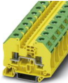
Schutzleiterklemme mit Bolzenanschlusstechnik, Querschnitt: 0,1 - 6 mm 2 , AWG: 26 - 10, Breite 16,3 mm, Farbe: grün-gelb
