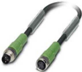
Sensor-/Aktor-Kabel, 3-polig, PUR halogenfrei, schwarzgrau RAL 7021, Stecker gerade M8, auf Buchse gerade M8, Kabellänge: 10 m
