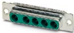
D-SUB-Kontaktträger, Shell-Größe 3, Aufnahme für 5 Kombinationskontakte, Kontaktart Buchse, gerade, Befestigung mittels Bohrung 3 mm, für Anbaurahmen und Tüllengehäuse VS-25-...
