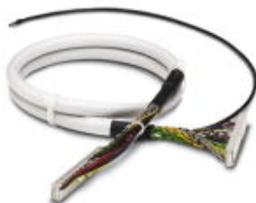
Konfektioniertes, geschirmtes Rundkabel, mit zwei 14-poligen Federleisten (1:1 Verbindung), u.a. zur Übergabe von 8 Kanälen, Länge: 3 m
