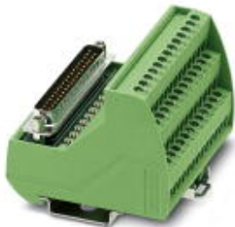
VARIOFACE-Modul, mit Schraubanschluss und D-SUB-Miniatur-Buchsenleiste, zur Montage auf NS 35-Tragschienen, mit LED, Polzahl: 37
