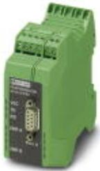
Modularer Repeater zur Potenzialtrennung und Reichweitenerhöhung für PROFIBUS bis 12 MBit/s, 4-Wege-Trennung, schienenmontabel, Versorgung 24 V DC
