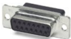
D-SUB-Kontaktträger, Shell-Größe 2, für 15 Signalkontakte, Kontaktart Buchse, für Crimpkontakte, gerade, Befestigung mittels Bohrung 3 mm, für Anbaurahmen und Tüllengehäuse VS-15-...
