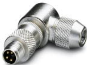
Sensor-/Aktor-Steckverbinder, Stecker, gewinkelt, 4-polig, M8 geschirmt, Lötanschluss, Metallrändel, Kabeldurchmesser max. 5 mm
