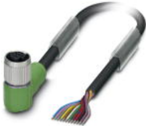
Sensor-/Aktor-Kabel, 12-polig, PVC, schwarz RAL 9005, freies Leitungsende, auf Buchse gewinkelt M12 SPEEDCON, A-kodiert, Kabellänge: 10 m
