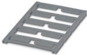
Einrastschildchen, Matte, silber, unbeschriftet, beschreibbar mit: BLUEMARK CLED, BLUEMARK LED, Plotter, Montageart: Verrasten in Schildchenträger, Schriftfeldgröße: 27 x 8 mm
