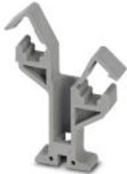
Doppel-Auflagebock, aus Isolierstoff, wahlweise verwendbar für Sammelschiene 3 mm x 10 mm oder 6 mm x 6 mm, Höhe: 48 mm
