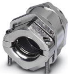
Metall-Verschraubung mit Zugentlastungsschelle, Gewindelänge: 8 mm, Leitungsdichtbereich : 24 - 33 mm, Klemmbereich: 26 - 36 mm, SW 50, Verschraubung: M40
