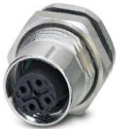
Sensor-/Aktor-Einbaubuchse, 5-polig, M12-SPEEDCON, geschirmt, B-kodiert, Hinterwand-/Schraubmontage mit Pg9-Gewinde, mit geradem Lötanschluss
