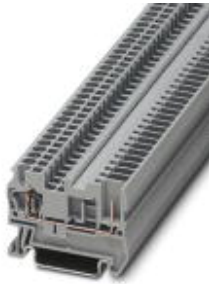
Durchgangsklemme, Anschlussart: Zugfeder- / Steckanschluss, Querschnitt: 0,08 mm 2 - 4 mm 2 , AWG: 28 - 12, Breite: 5,2 mm, Farbe: grau, Montageart: NS 35/7,5, NS 35/15
