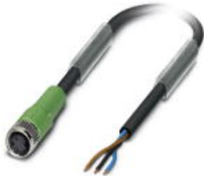
Sensor-/Aktor-Kabel, 3-polig, PVC, schwarz RAL 9005, freies Leitungsende, auf Buchse gerade M8, Kabellänge: 10 m
