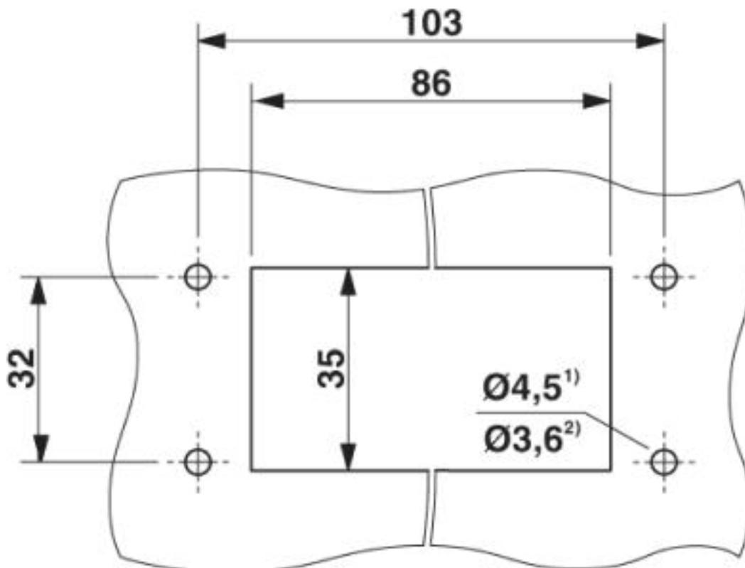
Montageausschnitt<sup>2)</sup> bei Einsatz von selbstfurchenden Schrauben (Torx® 20, M4)
