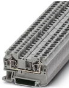
Durchgangsklemme, Anschlussart: Zugfederanschluss, Querschnitt: 0,08 mm 2 - 6 mm 2 , AWG: 28 - 10, Breite: 6,2 mm, Farbe: rot, Montageart: NS 35/7,5, NS 35/15
