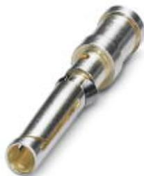
Gedrehter 1,6er Crimpkontakt, Buchsen-Einzelkontakt, Aderquerschnitt 2,5 mm<sup>2</sup>, versilbert
