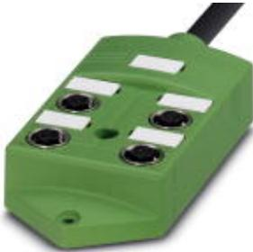
Sensor-/Aktor-Box, Anschlussart: M12-SPEEDCON-Buchse Metall, Anzahl der Steckplätze: 4, Polzahl: 5, Steckplatzbelegung: doppelt, Statusanzeige: Nein, Universal; Stammlenitungsanschluss: Festanschluss 180°, PUR/PVC, Leitungslänge: 10 m, Schirmung: nein
