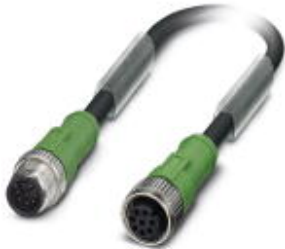
Sensor-/Aktor-Kabel, 8-polig, PUR halogenfrei, schwarzgrau RAL 7021, Stecker gerade M12, A-kodiert, auf Buchse gerade M12, A-kodiert, Kabellänge: 0,3 m
