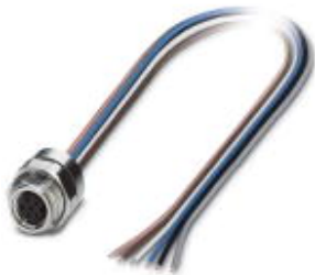
Sensor-/Aktor-Einbaubuchse, 6-polig, M8, Hinterwand-/Schraubmontage mit M12-Gewinde, mit 0,5 m TPE-Litze, 6 x 0,14 mm 2
