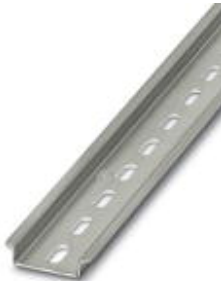
Tragschiene NS 35, nach Kundenwunsch, gelocht, Höhe: 7,5 mm, Breite: 35 mm
