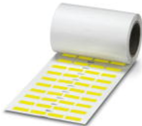
Etikett, Rolle, gelb, unbeschriftet, beschriftbar mit: THERMOMARK ROLL, THERMOMARK X, THERMOMARK S1.1, Montageart: Kleben, Schriftfeldgröße: 20 x 7 mm
