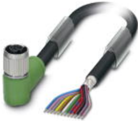
Sensor-/Aktor-Kabel, 12-polig, PUR/PVC, schwarz RAL 9005, geschirmt, freies Leitungsende, auf Buchse gewinkelt M12 SPEEDCON, A-kodiert, Kabellänge: 5 m
