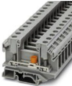
Universalklemme mit Bolzen-Anschluss, mit Trennschieber, Querschnitt: 0,1 - 6 mm 2 , Breite: 11 mm, Farbe: grau
