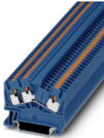
Durchgangsklemme, Anschlussart: Push-in-Anschluss, Querschnitt: 0,14 mm 2 - 4 mm 2 , AWG: 26 - 12, Breite: 5,2 mm, Farbe: blau, Montageart: NS 35/7,5, NS 35/15
