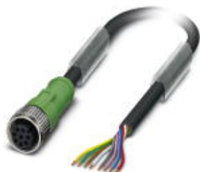
Sensor-/Aktor-Kabel, 8-polig, PUR halogenfrei, schwarzgrau RAL 7021, freies Leitungsende, auf Buchse gerade M12, A-kodiert, Kabellänge: 5 m
