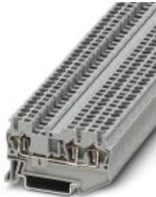
Durchgangsklemme, Anschlussart: Zugfederanschluss, Querschnitt: 0,08 mm 2 - 4 mm 2 , AWG: 28 - 12, Breite: 5,2 mm, Farbe: grau, Montageart: NS 35/7,5, NS 35/15
