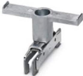
Auflagebock, Halterung für Sammelschienen, alle 20 cm zu setzen, Länge: 50 mm, Breite: 56 mm, Höhe: 33,7 mm, Farbe: silberfarben
