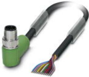
Sensor-/Aktor-Kabel, 12-polig, PVC, schwarz RAL 9005, Stecker gewinkelt M12 SPEEDCON, A-kodiert, auf freies Leitungsende, Kabellänge: 1,5 m
