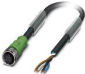
Sensor-/Aktor-Kabel, 4-polig, PUR, schwarzgrau RAL 7021, freies Leitungsende, auf Buchse gerade M12, A-kodiert, Kabellänge: 10 m
