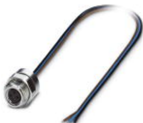
Sensor-/Aktor-Einbaubuchse, 3-polig, M8, Hinterwand-/Schraubmontage mit M12-Gewinde, mit 0,5 m TPE-Litze, 3 x 0,25 mm 2
