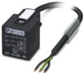
Sensor-/Aktor-Kabel, 3-polig, PUR/PVC, schwarz RAL 9005, freies Leitungsende, auf Ventilstecker A, mit 1 LED, beschaltet mit Z-Diode, Kabellänge: 1,5 m
