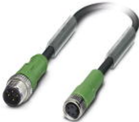
Sensor-/Aktor-Kabel, 4-polig, PUR halogenfrei, schwarzgrau RAL 7021, Stecker gerade M12, A-kodiert, auf Buchse gerade M8, A-kodiert, Kabellänge: 1,5 m
