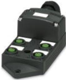
Sensor-/Aktor-Box, Anschlussart: M12-SPEEDCON-Buchse Kunststoff, Anzahl der Steckplätze: 4, Polzahl: 4, Steckplatzbelegung: einfach, Statusanzeige: Ja, pnp; Stammleitungsanschluss: Steckbarer Schraubanschluss 180°, Schirmung: nein
