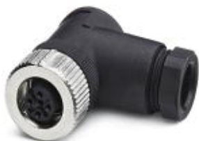
Sensor-/Aktor-Stecker, Buchse gewinkelt, 5-polig, M12-SPEEDCON, A-kodiert, Schraubanschluss, Metallrändel, Kabelverschraubung Pg9
