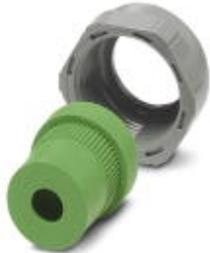
Halbverschraubung Pg16, aus Kunststoff, bestehend aus Dichtgummi mit einer Bohrung und einer Druckschraube, für Gehäuse der Bauform 1, Kabel [mm] 7 - 10,5
