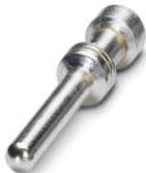
Gedrehter 2,5er Crimpkontakt, Stift-Einzelkontakt, Aderquerschnitt 0,75 bis 1,00 mm<sup>2</sup>, versilbert
