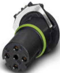
Bus-System-Einbaubuchse, ETHERNET, 4-polig, D-kodiert, mit geradem THR-Lötanschluss, nur Kontakteinsatz
