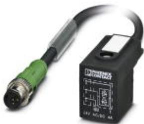
Sensor-/Aktor-Kabel, 3-polig, PUR halogenfrei, schwarzgrau RAL 7021, Stecker gerade M12, A-kodiert, auf Ventilstecker BI (11 mm), mit 1 LED, beschaltet mit Z-Diode, Kabellänge: 1,5 m
